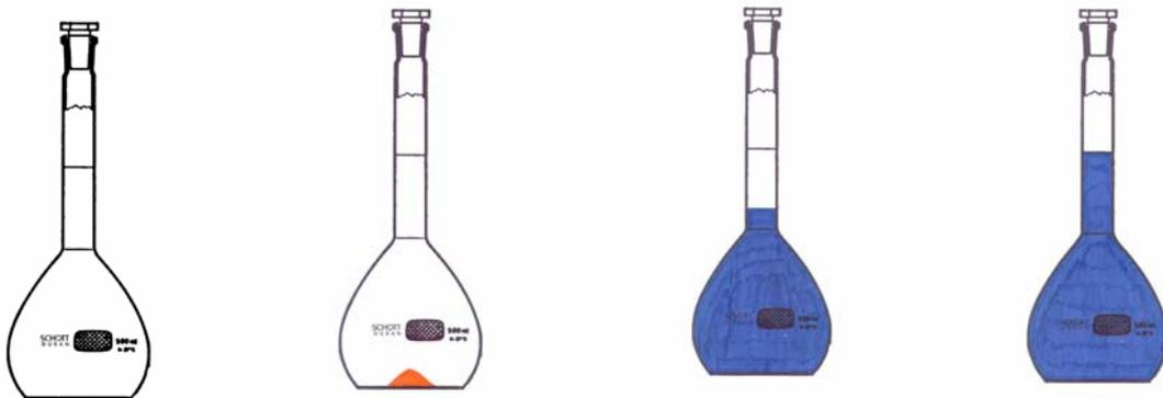
Die vier Schritte einer konventionellen Probenvorbereitung mittels „kalibrierter Messkolben.“
